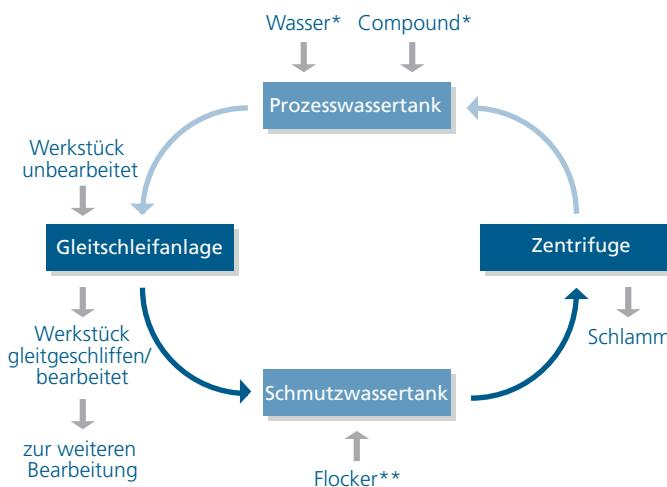
\* Durch Verschleppung und Verdunstung des Prozesswassers werden kontinuierlich Wasser und Compound ergänzt.
